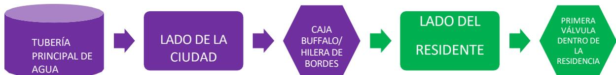
En virtud de la LSLRNA, como se ilustra a continuación, la Ciudad está obligada a reemplazar totalmente las líneas de servicio de plomo (o línea de servicio galvanizado aguas abajo de la línea de servicio de plomo) de la tubería principal de agua a la primera válvula de cierre (generalmente ubicado en el medidor) o 18 pulgadas dentro de una residencia, lo que sea más corto.
